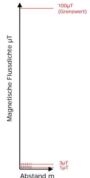
Symmetrische Belastung beider Systeme mit 60 % der Übertragungsleistung von 200 MVA, Lastfluss in eine Richtung mit phasenoptimierter Seilbelegung
