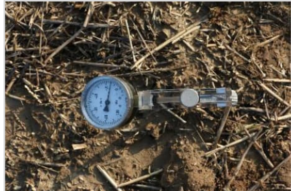
Abbildung 23: Messung der Bodenwasser-spannung mittels Tensiometer (© Schnittstelle Boden)
