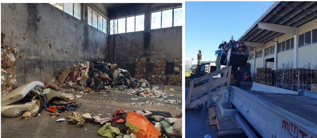
Abbildung 9: Teilprobenziehung mittels Radlader
