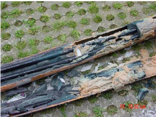
Abbildung 23, Detail Bentoniteinschluss
