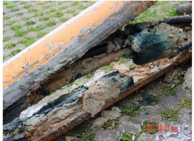
Abbildung 22, Einschluss Bentonitsuspension
