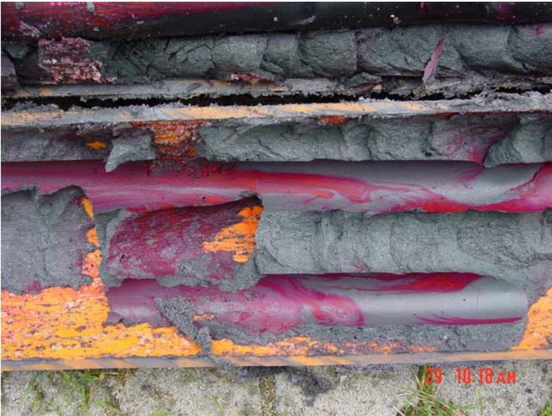
Abbildung 44, Anlagerung des Farbtacers im Bereich der Sondenverrohrung bei Verpresskörper 2
