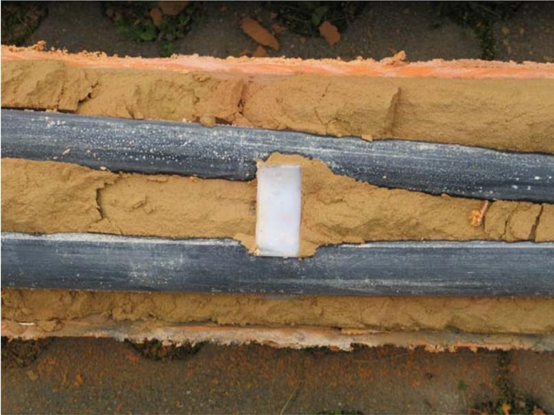
Abbildung 42, Vollständige Umhüllung des Abstandhalters bei Verpresskörper 5
