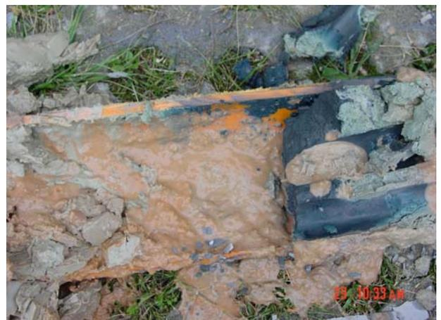
Abbildung 26, Detail Einschluss Bohrspülung
