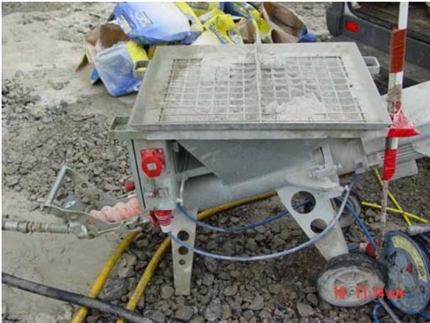
Abbildung 7, Schneckenpumpe zum Anmischen
