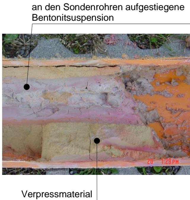
Abbildung 46, Verpresskörper 5, Detail Bereich Sondenverrohrung
