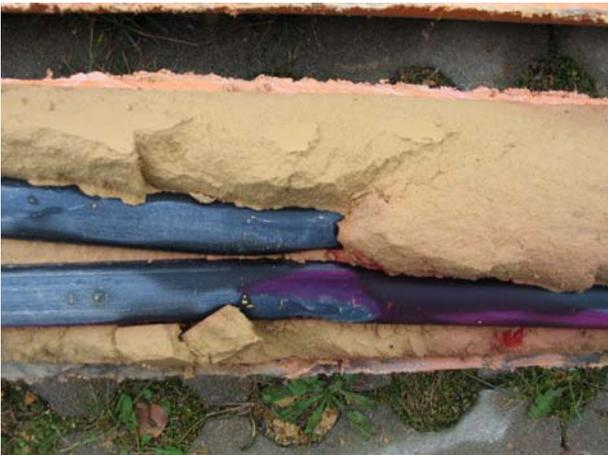
Abbildung 29, Detail Anlagerung Tracer an Sondenrohren
