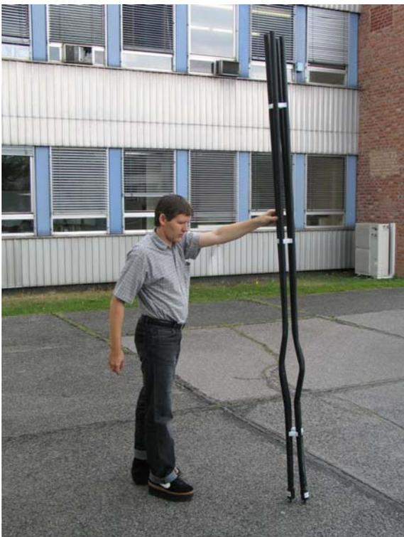
Abbildung 11, Knick in Sondenverrohrung
