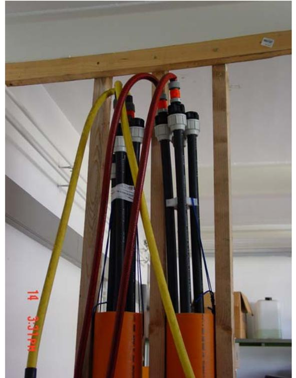
Abbildung 6, Druckbeaufschlagung Sondenrohre
