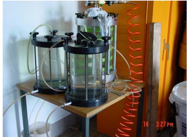
Abbildung 10, Druckzylinder mit Druckregelung
