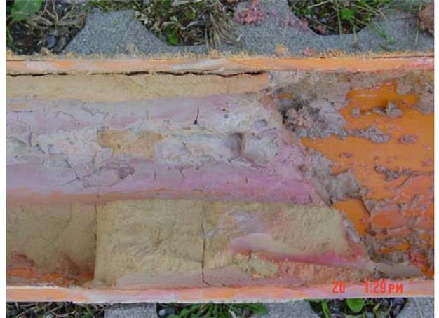
Abbildung 37 und 38, VK5 Bentoniteinspülung entlang der Sondenverrohrung
