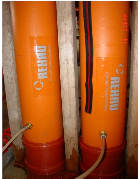
Abbildung 8, Wasserzufluß am unteren Rohrende
