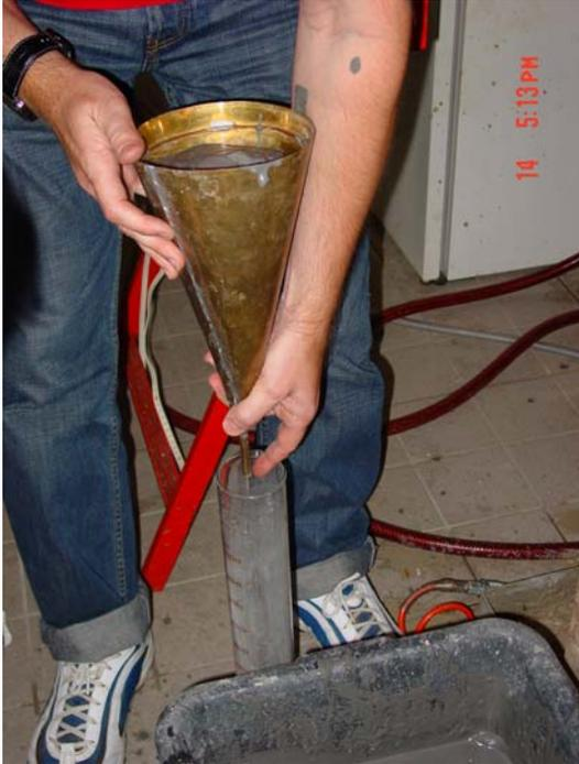
Abbildung 2: Bestimmung der TAZ mittels Marshtrichter
