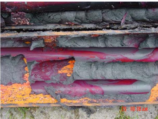
Abbildung 19, VK2, Detail Tracerablagerung an Grenzfläche zu Sondenverrohrung
