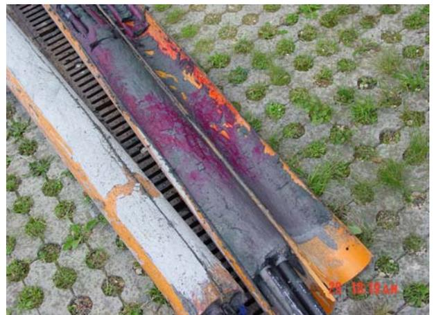
Abbildung 20, Tracerablagerung an Grenzfläche zum Außenrohr
