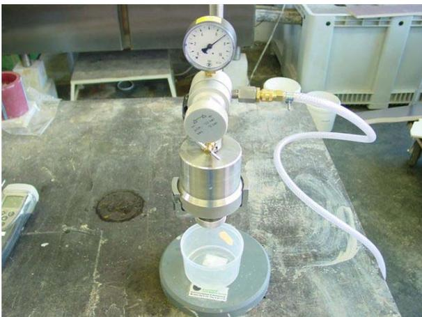
Abbildung 3: Filterpresse zur Bestimmung der Filtratwasserabgabe
