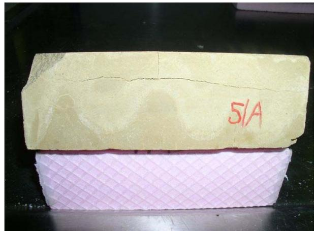
Abbildung 35, Quaderförmige Probekörper mit horizontalen Rissen und Abplatzungen
